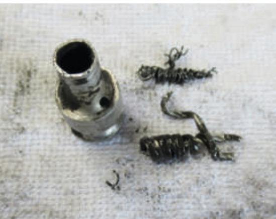
Mit einer Schieblehre habe ich den Durchmesser der Welle gemessen. Bei mir waren es 3 Millimeter. Danach wurde ein passender Bohrer gewählt um die Reste der Welle aus dem getrie-
