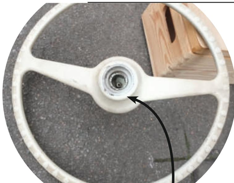
Das falsche Lenkrad mit dem eingewürgten Blechstreifen.
