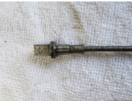
Welle mit ranzigem Öl verklebt. Nun war der Schadensablauf klar. Durch den erhöhten Reibungswiderstand in der Wellenummantelung versagte die Welle an der Stelle des größten anfallenden Drehmomentes. Und das ist typischerweise am Getriebeausgang.
