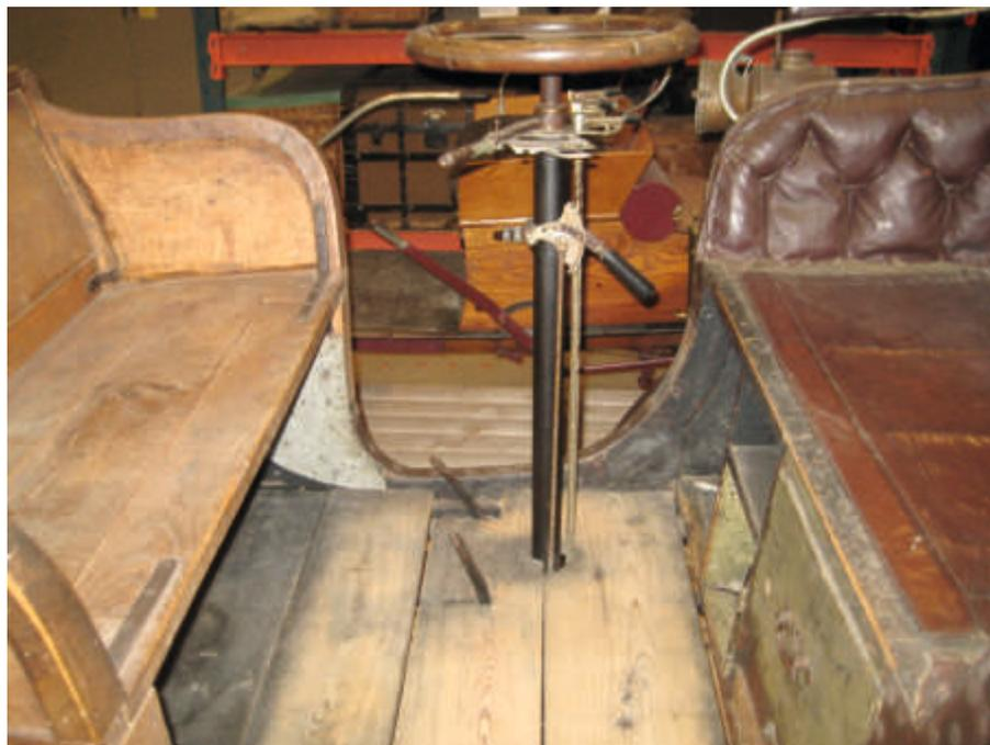
det, und auch die Typenabbildungen von John Hankins Motorwagen in Oswalds Buch, kann man nur feststellen, dass das Schwedische Auto das älteste ist. Die vertikale Lenksäule lässt sich dadurch dann leichter erklären.
